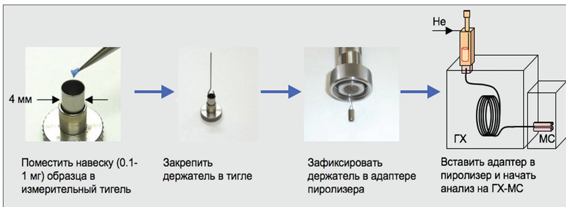
Рис. 2. Схема подготовки образца к анализу на Пиро-ГХ/МСД
